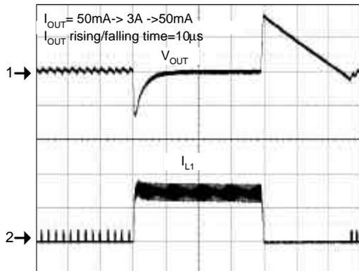
CH1 :  $V_{OUT}$ , 200mV/div
