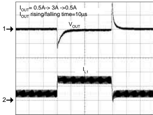
CH1 :  $V_{OUT}$ , 100mV/div
