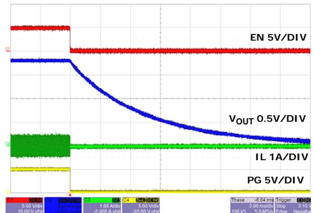
FIGURE 28. SOFT-DISCHARGE SHUTDOWN
