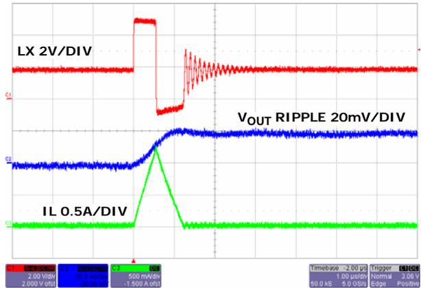
FIGURE 18. STEADY STATE OPERATION AT NO LOAD (PFM)
