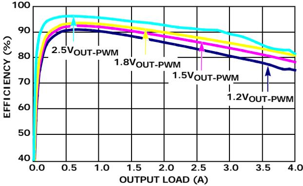
FIGURE 3. EFFICIENCY vs LOAD (1MHz 3.3  $V_{IN}$  PWM)
