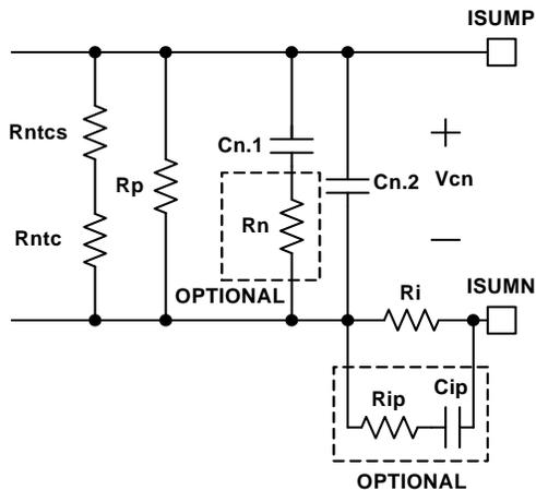
FIGURE 23. OPTIONAL CIRCUITS FOR RING BACK REDUCTION
