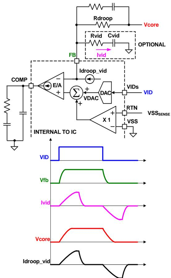
FIGURE 28. SLEW RATE COMPENSATION CIRCUIT FOR VID TRANSITION
